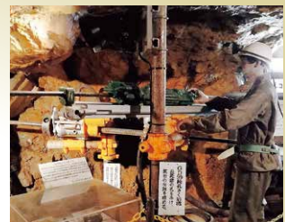
ボーリング作業 コアを採取して鉱脈をさがしています。
